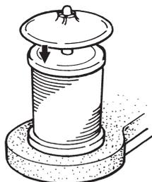
Retirer le bloqueur de vibration. Placer la bobine de fil sur la tige du support de bobine et fixer le disque de maintien, rebord arrondi tourné vers le bas, sur la tige du support de bobine.
