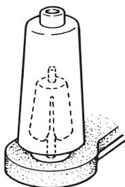
Lors de l'emploi de cônes de fil normaux, placer les antivibreurs sur les broches en tournant le côté le plus large vers le bas.
