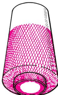
Pour les fils fins qui tombent facilement du cône, recouvrir les bobines avec la résille rangée dans la pochette d'accessoires.
